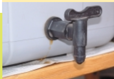
Dit kraantje werd niet lekdicht gemonteerd. Eens de bak in gebruik is het zo goed als onmogelijk om hieraan nog te verhelpen. Een gewaarschuwd wormenbakgebruiker...
